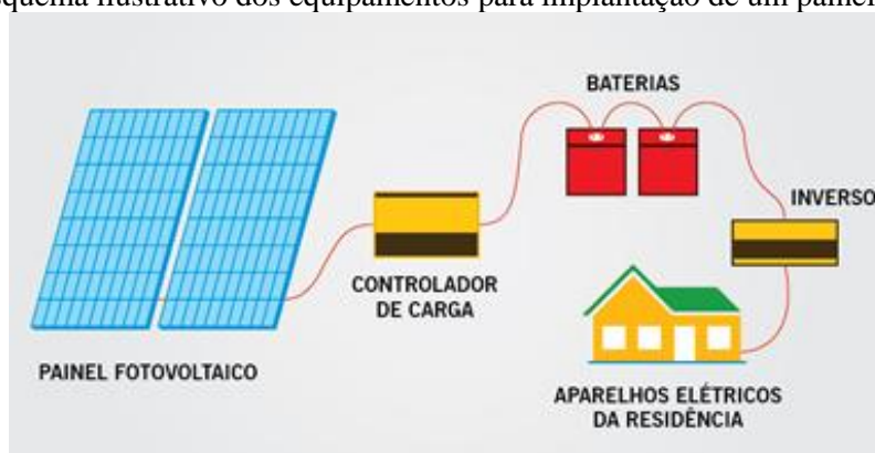
Figura 4 - Esquema ilustrativo dos equipamentos para implantação de um painel fotovoltaico.
